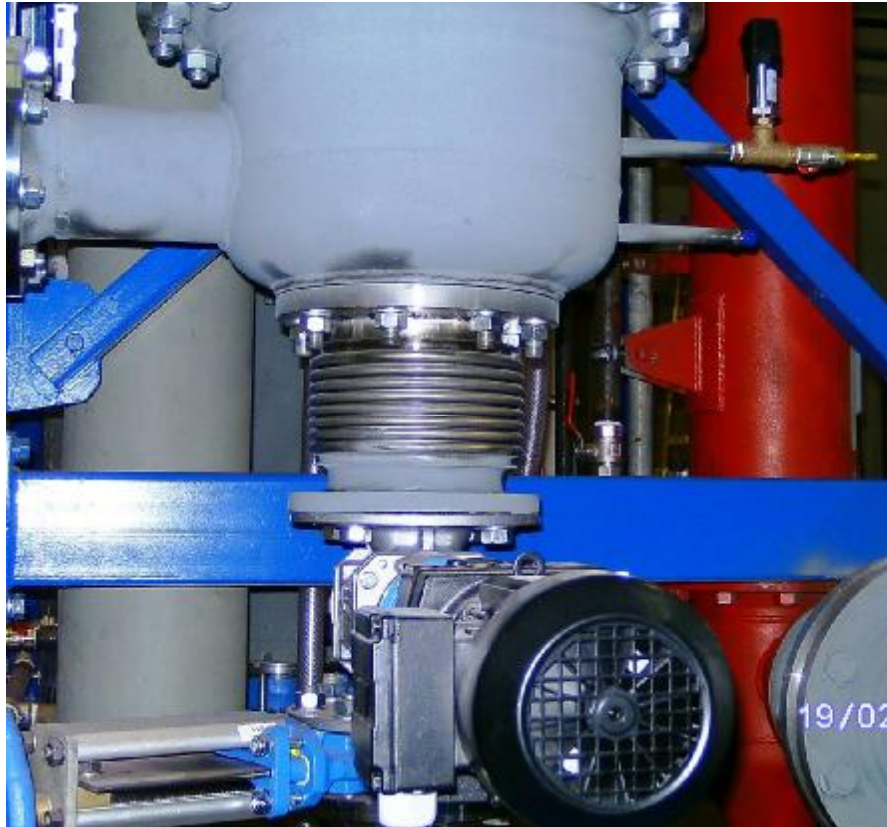
Feststoffaustrag am Wirbelschichtreaktor
