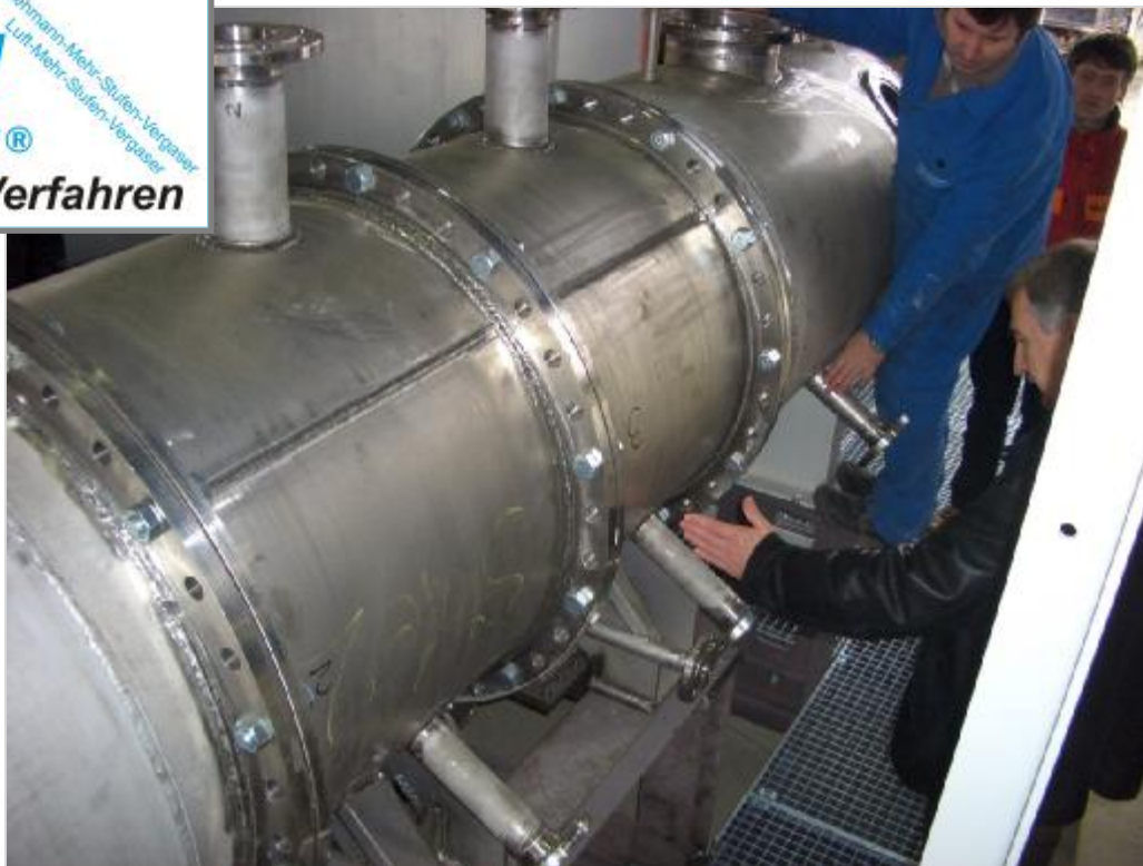
Bild 4 Modul 2 + 3 → Entgasungs- und Vergasungszone des LMSV ® 200
