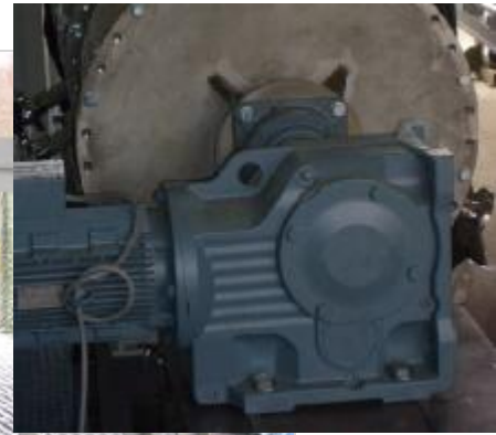
Vergaseraustragsseite mit Hauptwellenantrieb
