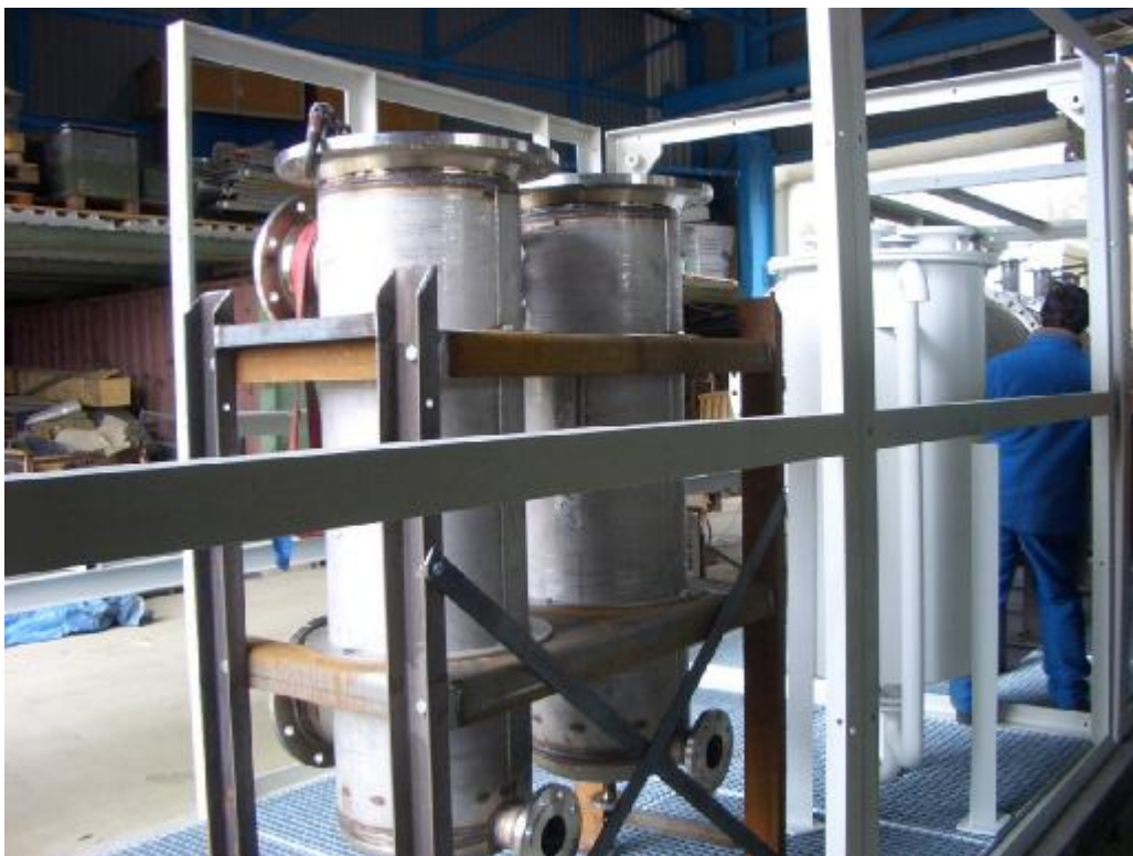
Bild 7 Brenngasnachreinigung und Sicherheitstauchung des LMSV ® 200
