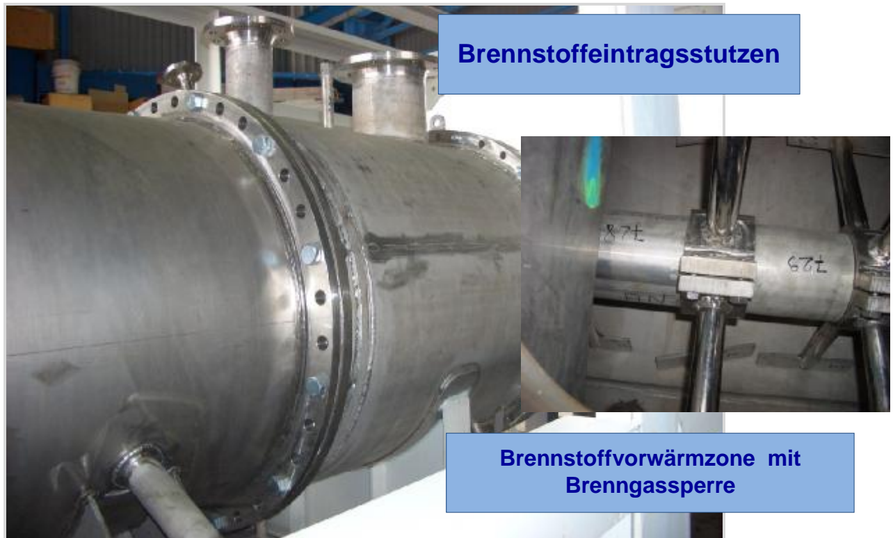
Bild 3 Modul 1 → Eintragsseite mit Aufheizzone für Brennstoffe im LMSV ® 200
